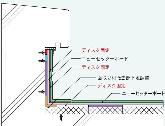
■ 劣化ランクC ニューセッターボードを用いて下地調整した場合の改修後
