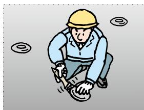
塩化ビニル樹脂製シートに接着剤やディスク板を用いて下地に張り付ける工法です。機械固定の場合、湿润下地でも施工可能です。
