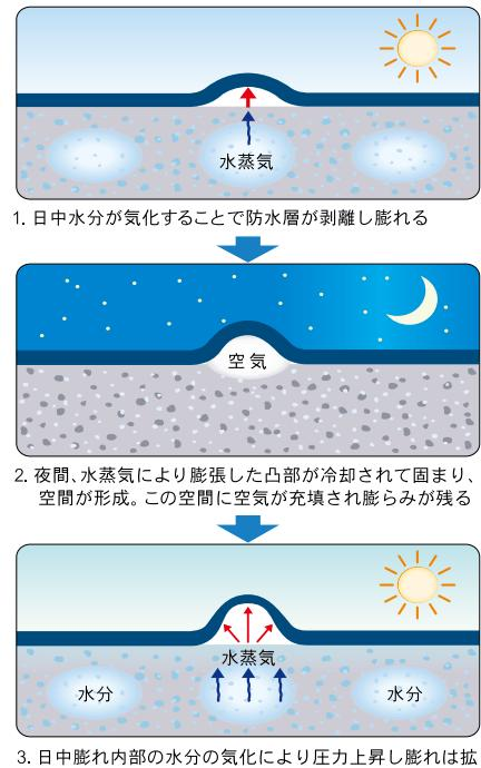
以上から防水層の膨れは、コンクリート内部の水分に起因することから、施工時のコンクリートの養生が十分であれば膨れは出にくくなります。しかし、近年は工期短縮のためコンクリート打設から十分な養生期間をとらずに防水を施工することが多く、膨れが多くなる傾向があります。また経年した保護コンクリートは、自然環境にさらされているため劣化が進行し吸水しているため、より膨れが出やすい傾向にあります。
