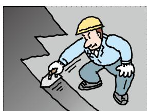
カイザーコート工法は、高伸長ウレタンでありながら高強度ウレタンの物性を併せ持つ塗膜物性により、メッシュフリー工法を可能にしました。また、リファージュ、セピロンは、一般的のウレタン防水より硬化が速く、リファージュに関しては可使時間も長いため、施工性に優れています。
