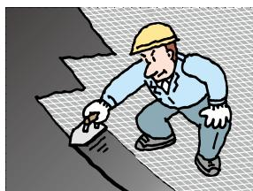
表層にフィルム加工した改質アスファルトルーフィングを、裏面の粘着層により下地に張付け、その上にウレタンゴム系塗膜防水を塗布し、シームレスな防水層を形成する工法です。
